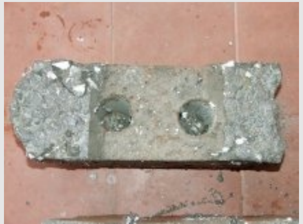
Fig. 6 Bloques intertrabados con agregado de EPS, con huecos para disminuir su peso.
