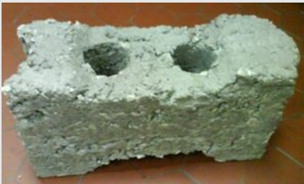
Fig. 5 Bloques intertrabado donde se atendió tanto al tamaño de los chips de EPS como a un tratamiento previo del molde.
