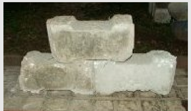
Fig. 4 Bloques intertrabados materializados con un mayor porcentaje de EPS, sin control del tamaño de los chips.
