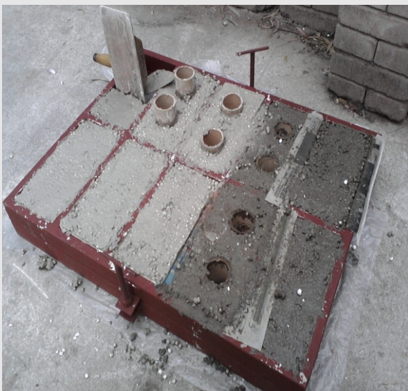
Fig. 8 Mampuestos macizos y con huecos, de mayor altura.
