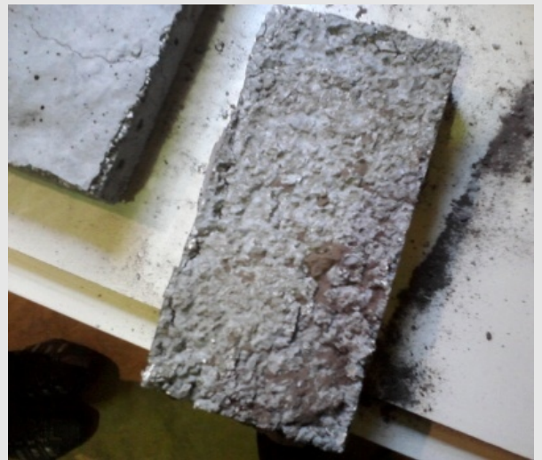
Fig. 7 Mampuestos que incorporan EPS, de dimensiones similares a las de los ladrillos comunes, en los que se trató especialmente el molde para evitar irregularidades superficiales.
