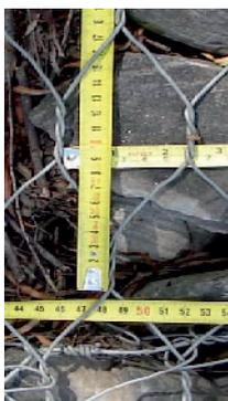
Fig. 9 Amplias deformaciones (Detalle de la figura 10).
