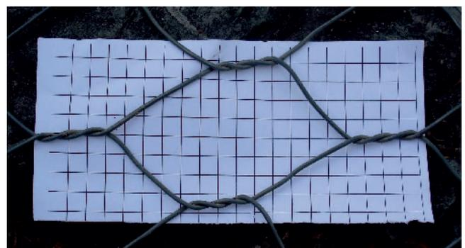
Fig. 11 La cuadrícula facilita la apreciación de las deformaciones.
