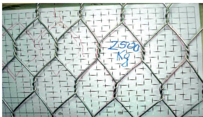
Fig. 41 Probeta de malla 6x8 - 2,34 angostada – F=2500 Kg., sobre cuadrícula de fondo.
