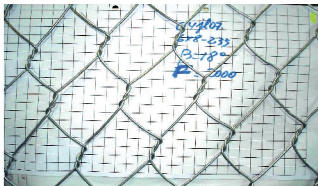
Fig. 43 Probeta de malla 6x8 - 2,34 natural sometida a corte, con inclinación de 18°, carga de 2000 Kg., sobre cuadrícula de fondo.
