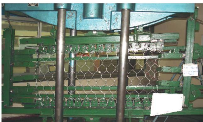
Fig. 42 Probeta de malla 6x8 - 2,34 natural sometida a Corte, con inclinación de 18°.
