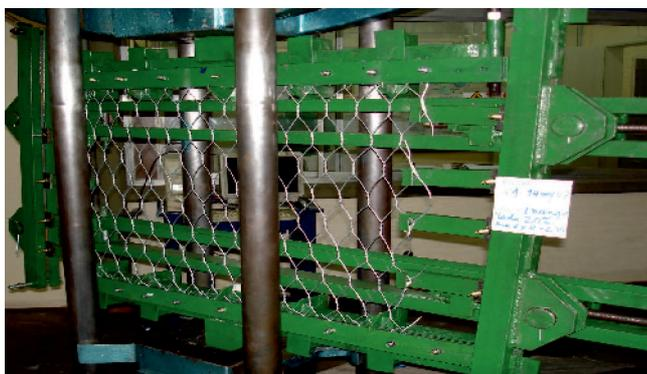
Fig. 40 Probeta de malla 6x8 - 2,34 angostada montada en el marco.
