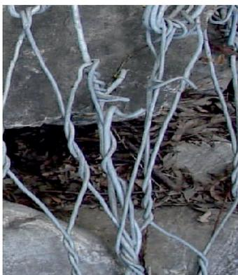
Fig. 14 Resistencia del enrollamiento.
