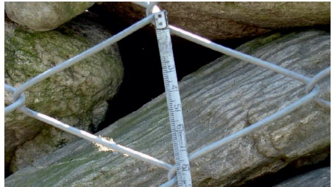
Fig. 20 Medición de diagonal transversal.
