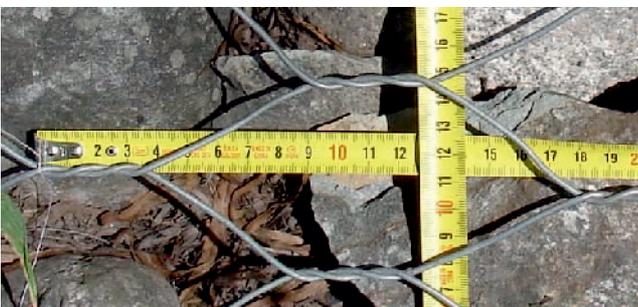
Fig. 8 Detalle de la medición con cintas métricas.
