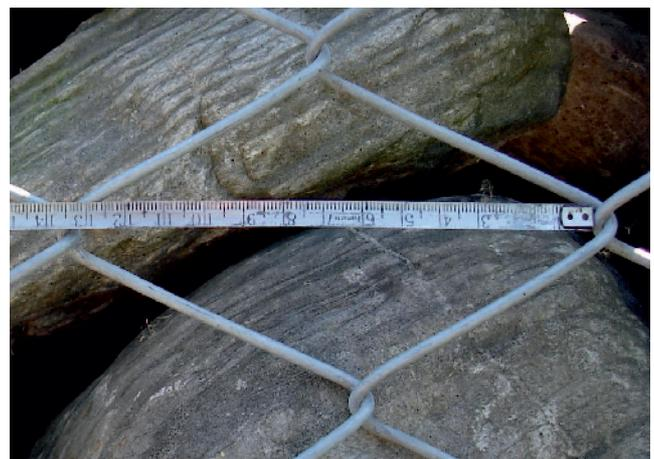
Fig. 21 Medición de diagonal longitudinal.
