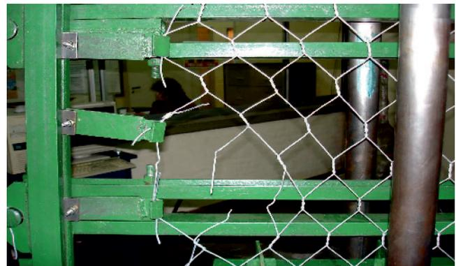
Fig. 38 Probeta de malla 8x10 - 2,5 ensanchada – Rotura en el alambre de bobina. Los alambres de borde fueron cortados antes de iniciar el ensayo.
