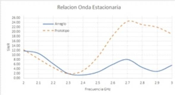
Fig. 15 Comparativa de la relación de onda estacionaria para el arreglo.
