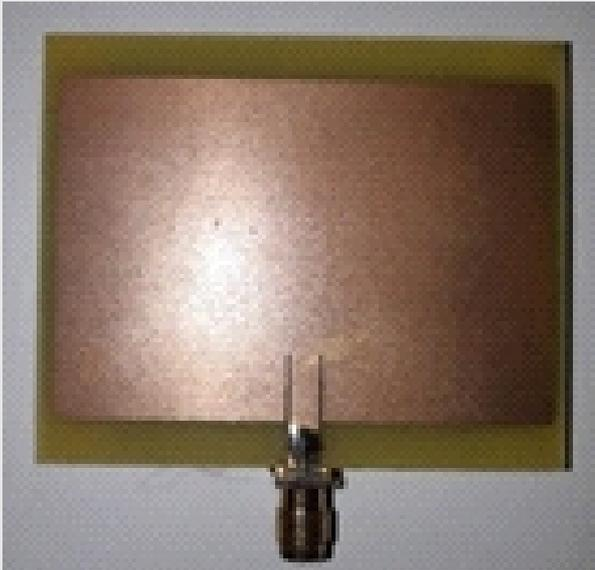
Fig. 11 Antena parche prototipo.
