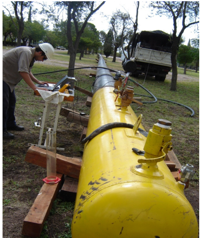
Mediante procedimientos de desarrollo propios, se realizan ensayos de prueba hidráulica en gasoductos de alta presión, donde se verifican resistencia del material, estanqueidad y fluencia entre otros parámetros.
