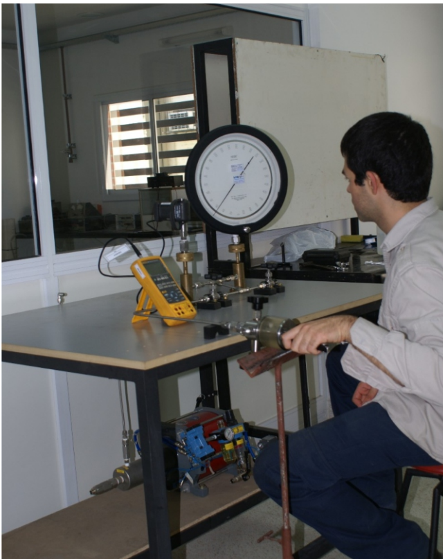
Ensayos interlaboratorios de presión. En la fotografía, un manómetro viajero de referencia, es calibrado con un patrón del laboratorio.
