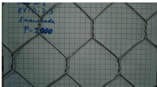
Fig. 11 Probeta de malla 8x10 - 2,5 ensanchada – F=2000 Kg sobre cuadrícula de fondo.
