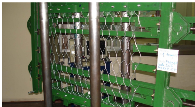
Fig. 12 Probeta de malla 6x8 - 2,34 angostada montada en el marco.
