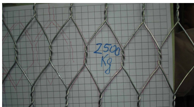
Fig. 13 Probeta de malla 6x8 - 2,34 angostada – F=2500 Kg., sobre cuadrícula de fondo.
