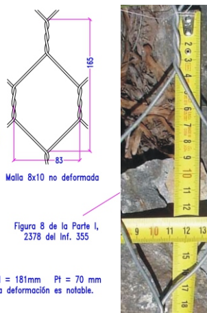
Fig. 1b Al modificar idealmente PI , las barras giran con fuerza pequeña, F \sim 0 , generando nuevas mallas.
