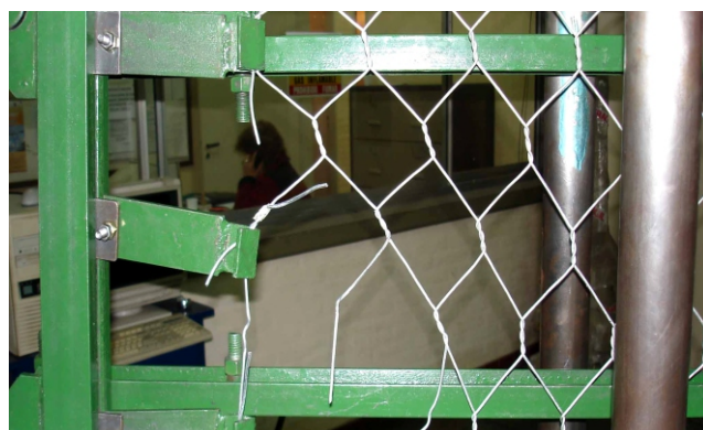
Fig. 10 Probeta de malla 8x10 - 2,5 ensanchada – Rotura en el alambre de bobina. Los alambres de borde fueron cortados antes de iniciar el ensayo.
