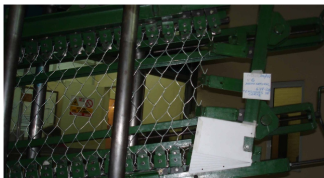
Fig. 14 Probeta de malla 6x8 - 2,34 natural sometida a Corte, con inclinación de 18°.
