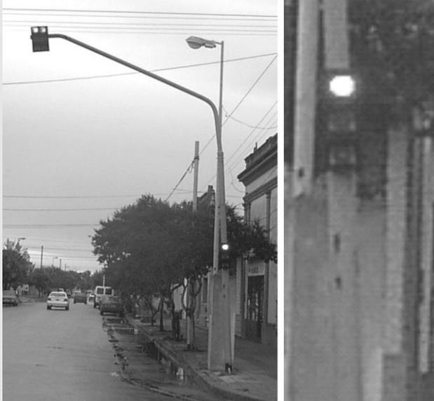
Fig. 5 Semáforo con unidad óptica con forma y dimensiones inadecuadas.
