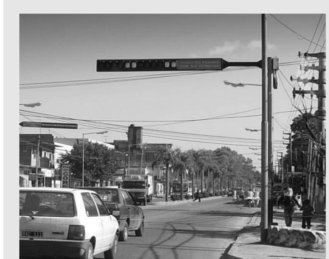
Fig. 9 Ubicación inadecuada de luces en semáforos horizontales.
