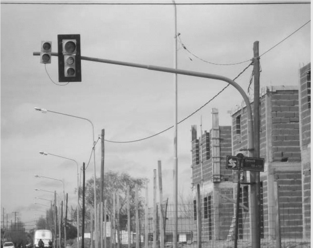
Fig. 11 Señal de semáforo obstaculizada por un nomenclador.
