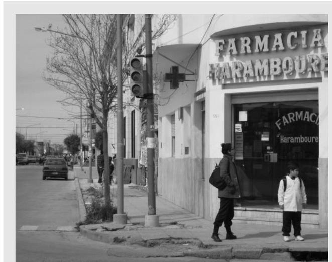
Fig. 10 Poste de semáforo obstaculizando la circulación peatonal.
