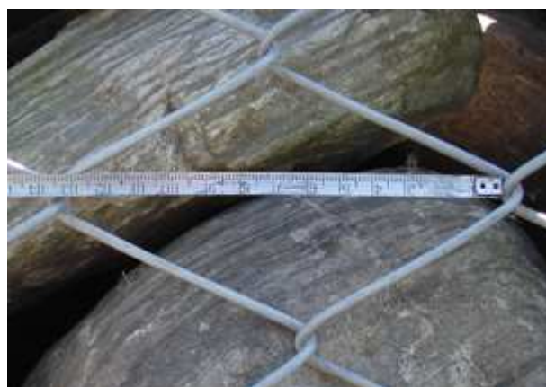
Fig. 21 Medición de diagonal longitudinal.
