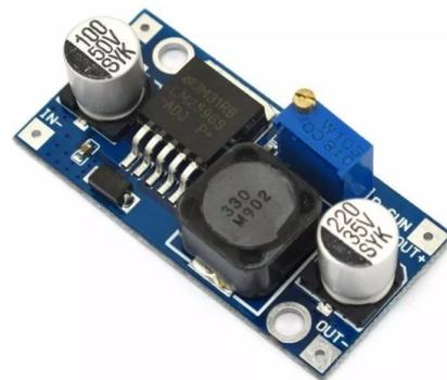
Figura 15. Regulador reductor eficiente de tensión.
