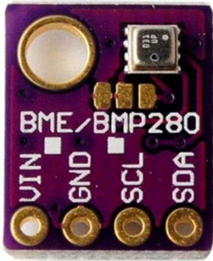
Figura 11. Sensor de humedad, presión y temperatura BME/BMP280.
