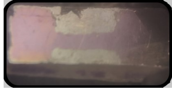
Figura 2: Canal definido por el etching químico.
