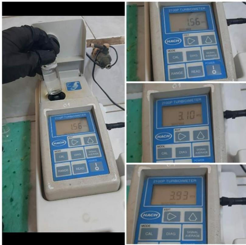
Ilustración 10. Medición de turbidez.
