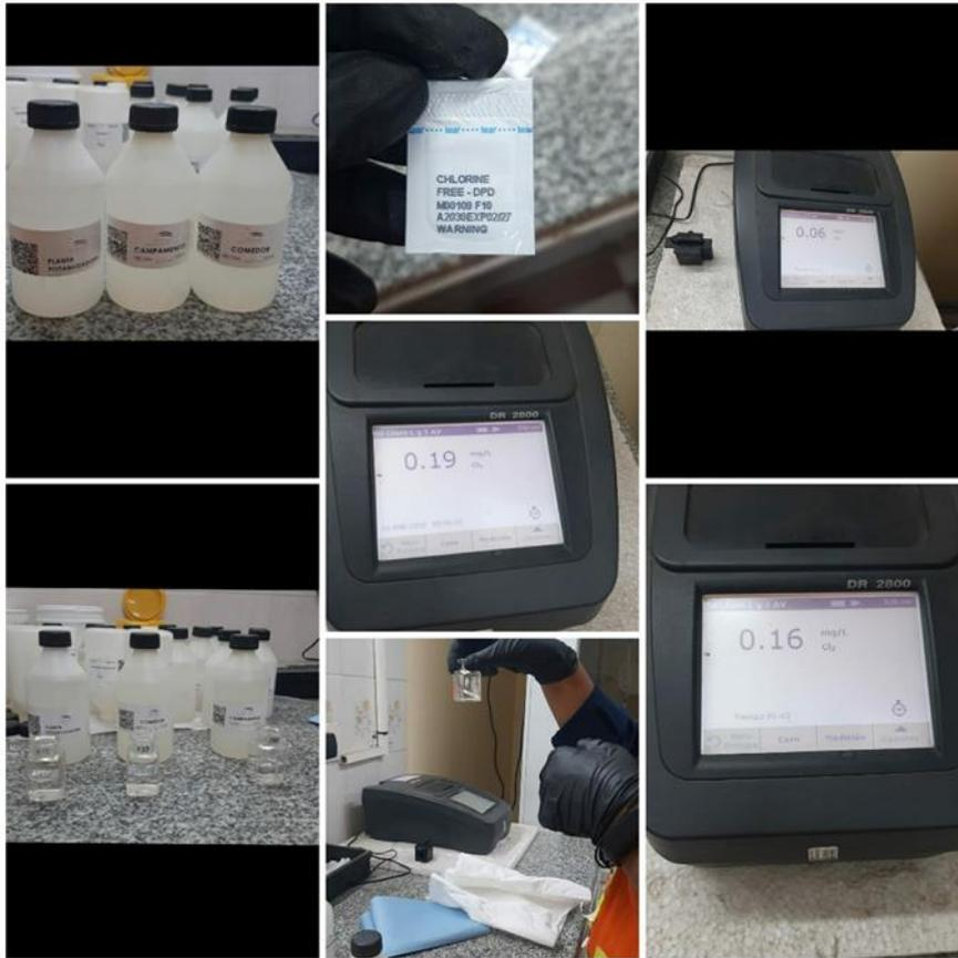
Ilustración 9. Medición de Cloro.
