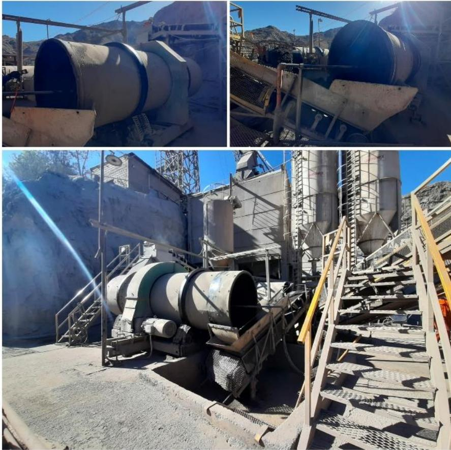
*Ilustración 58 Aglomerador 1, boca de descarga palaya II.*
