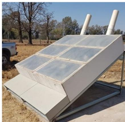
Figura 1: Vista frente y lateral del secadero
