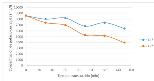
Figura 6. Concentración de potasio (mg/L) corregida para cada muestra electrolizada (ensayo 4). La curva azul corresponde a la concentración corregida por dilución y la curva naranja, a la corrección por cambio de volumen.
