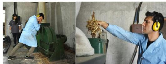
Figura 5: Reducción primaria y secundaria del rastrojo en astilladora y molino.
