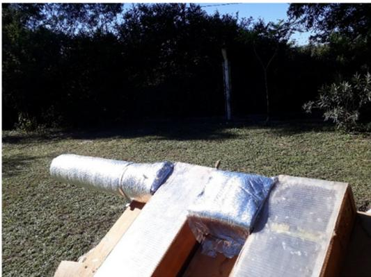
Figura 2: Colectores solares conectados en serie, mediante una unión.
